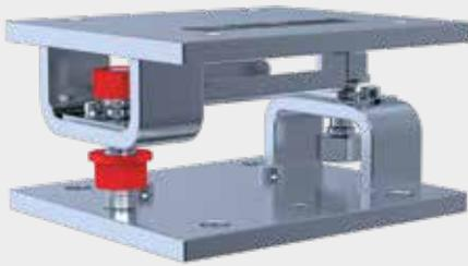
Supports à double fonction : by-pass pour soutenir le chargement pendant les activités d'installation, d'entretien et de transport du silo, et antiretournement quand le capteur est en service.
