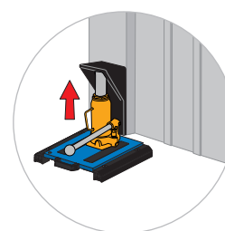
SOLUTION 2 Peser le conteneur en le soulevant à l'aide de vérins posés sur les plateformes.
